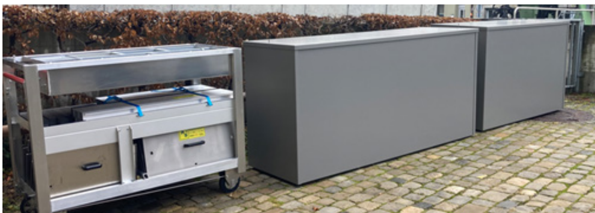
Compacts, protégés des impuretés et mis en service rapidement : les éléments de protection sont placés sur le module roulant (à gauche). Le module est stocké dans des caisses spéciales (à droite).
